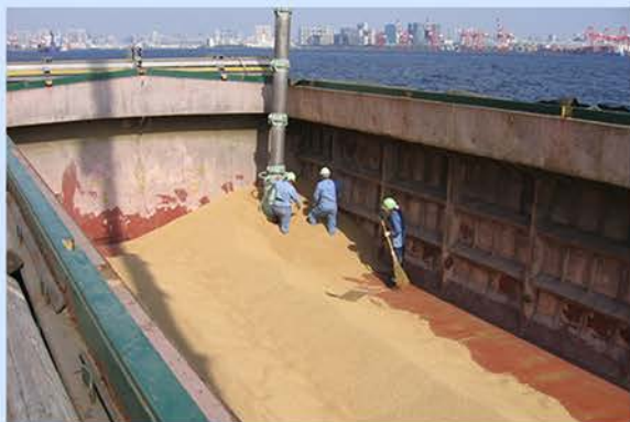
小麦の揚荷役作業
